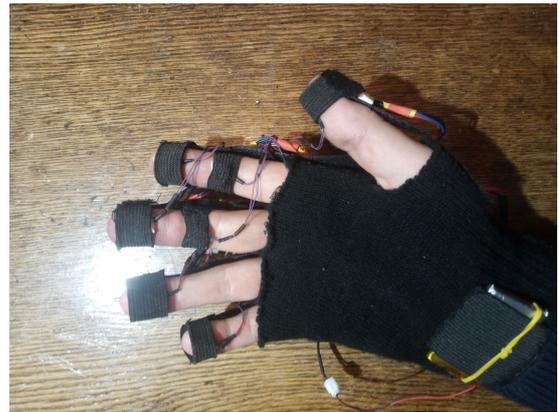
Abbildung 5: Handschuh mit installierten Vibrationsmotoren
