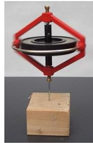
**Abbildung 2.2:** Das einfachste mechanische Gyroskop: ein Kreisel
