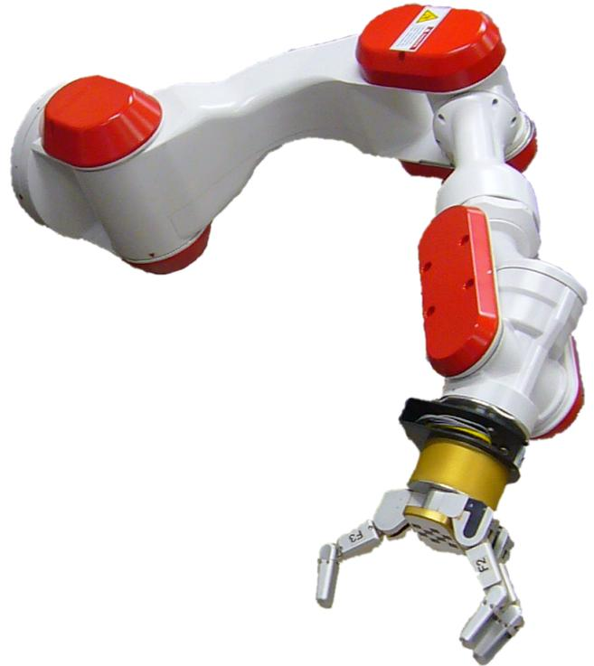
**Abbildung 3.8:** Portable Arm 10-6C vom Mitsubishi Heavy Industries Ltd. mit Barret-Hand
