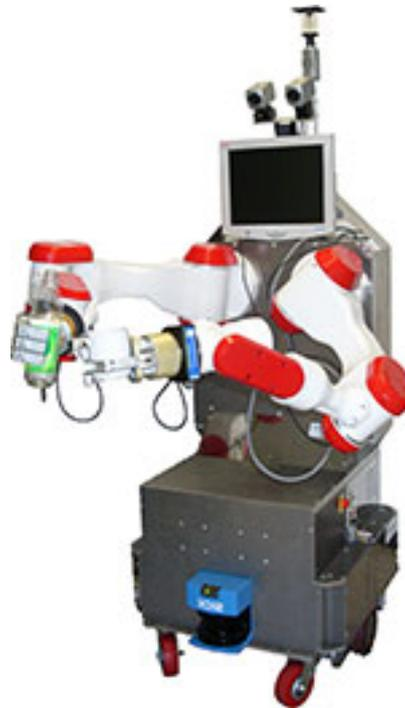
**Abbildung 3.7:** Der TASER mit 2 montierten PA10 und einer Omnidirektionalen Kamera
