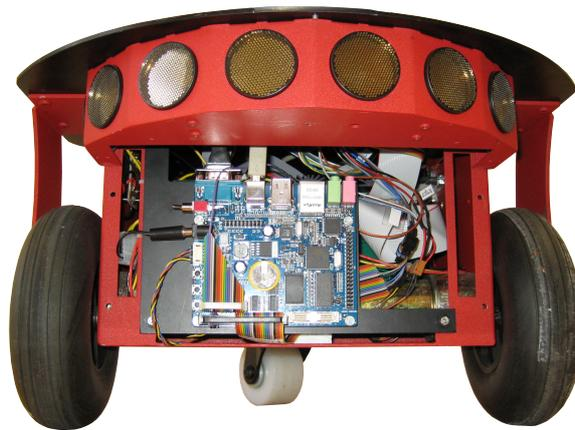
*Abbildung 13: Das Mikrocontrollerboard in die Front des Pioneer eingesetzt*
