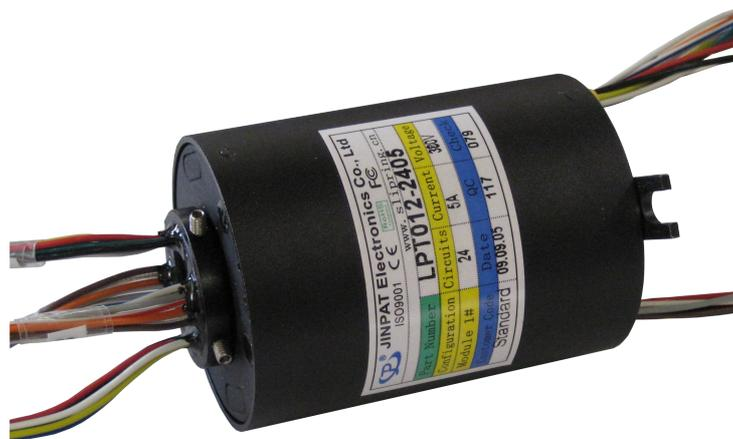
Abbildung 8: Foto des Schleifrings
