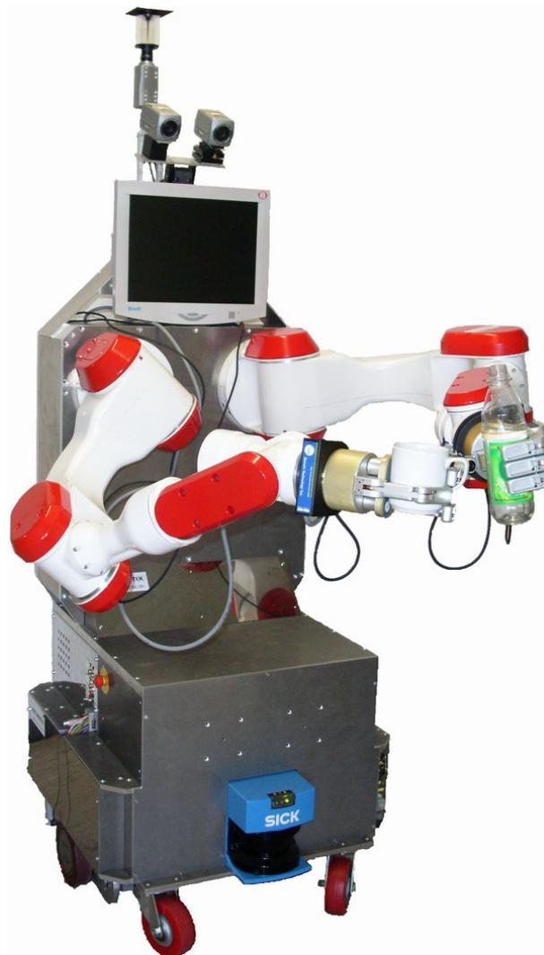
Abbildung 2.6: Der Serviceroboter des Arbeitsbereich TAMS in ursprünglich angestrebter Ausbaustufe mit zwei Armen.
