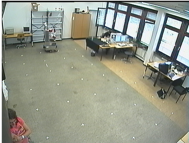
Abbildung 2.7: Die weißen Punkte auf dem Boden des Robotiklabors des AB TAMS dienen als Marken für die Kamerakalibrierung.
