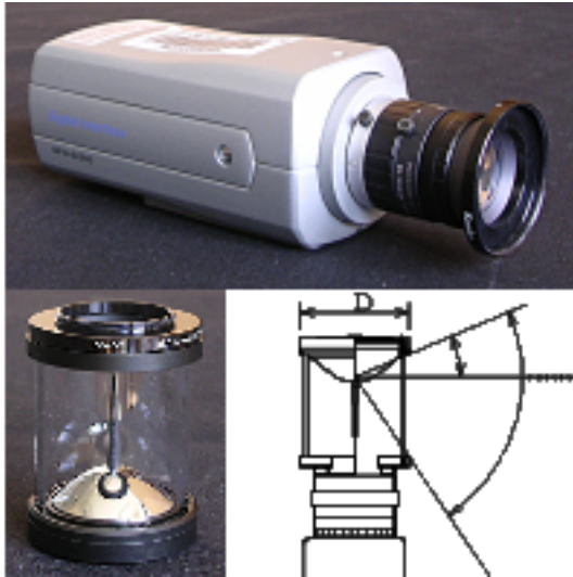
Abbildung 1.3: Für diese Arbeit verwendete Kamera und Spiegel. Rechts unten eine schematische Darstellung des Öffnungswinkels vom Spiegel.
