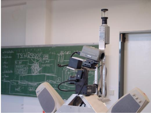
(a) Bild der automatisch geneigten PTU mit Kamera.
