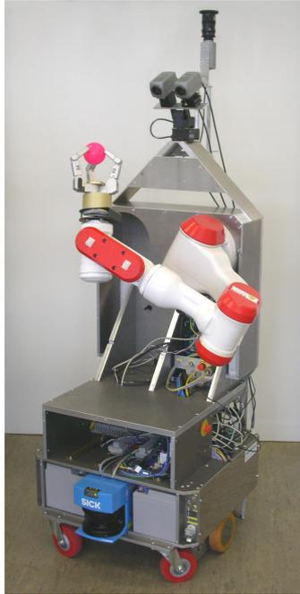
Abbildung 3.1: Der Service-Roboter des AB TAMS am Fachbereich Informatik der Universität Hamburg
