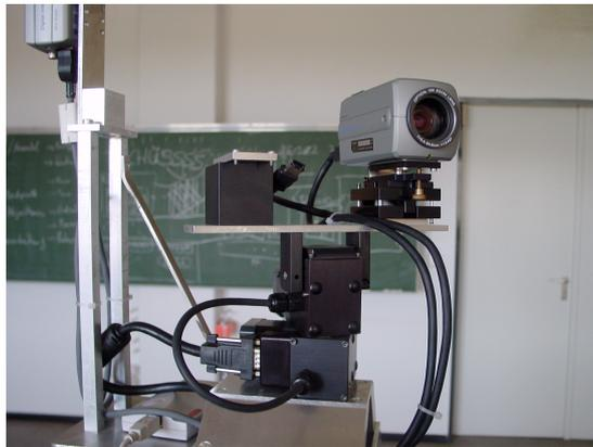
Abbildung 3.2: Die PTU mit einer der beiden Kameras des Roboters. Die PTU erlaubt Drehung und Neigung der Kamera.
