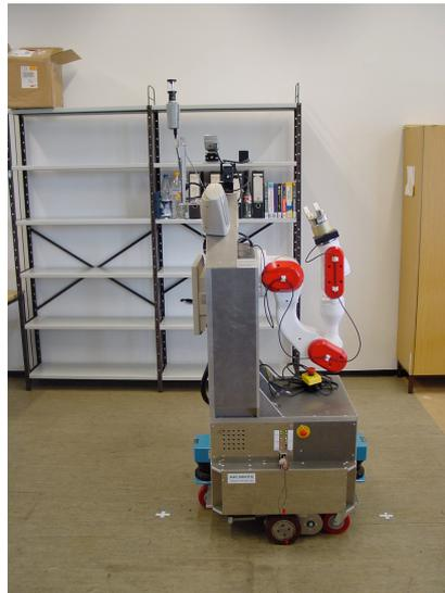
Abbildung 6.3: Die Ausrichtung des Roboters erfolgt parallel zum Regal, das sich auf der linken Seite befinden soll. Andere Ausrichtungen sind leicht umzusetzen.
