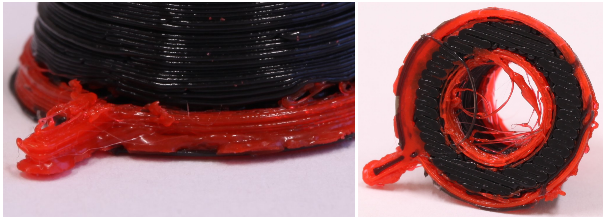
Abbildung 3.1. – Auswirkung unsauberer Retraction nach Extruderwechseln. Bei großem Düsendurchmesser (schwarz, 0.5mm) ist der Effekt deutlich schwächer als bei kleinem Durchmesser (rot, 0.25mm).
