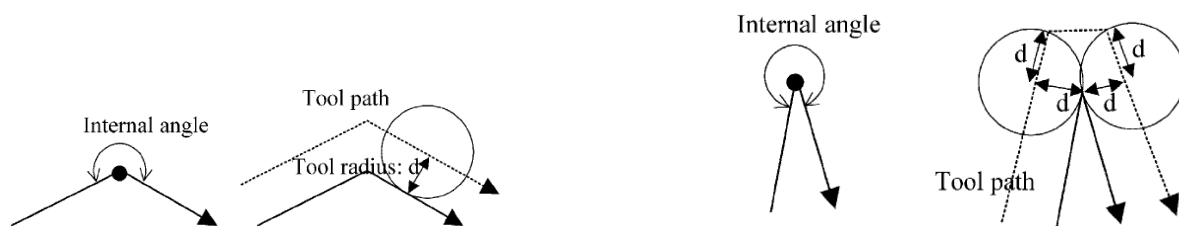
Abbildung 4.6. – Verlauf des mitered offset bei einem internen Winkel \leq 1.5\pi (links) und \geq 1.5\pi (rechts). Abbildung aus [PC03, Fig. 4.]
