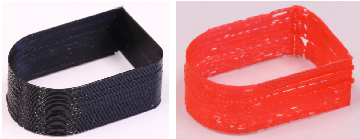
Abbildung A.4. – Erzeugung dünner Wände mit einem geeigneten Extrusionsfaktor ( f_e = 1.5 ) links, und einem zu großen ( f_e = 2.0 ), bei gleichzeitig schlechterer Filamentqualität rechts.
