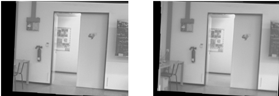
Abbildung 9.14: Rektifiziertes Stereobildpaar. Die Rektifikation überführt die Stereoaufnahme der allgemeinen Stereogeometrie in die Bilder der Standardstereogeometrie. Dadurch wird die Suche korrespondierender Punkte der Korrespondenzanalyse von zwei auf eine Dimension eingeschränkt.
