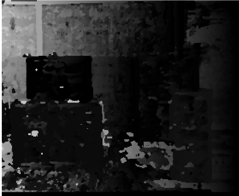
Abbildung 9.19: Mit dem Shirai-Algorithmus generierte Disparitätskarte. Die Grauwerte des Bildpunktes bilden die Basis zur Rekonstruktion der Tiefeninformation der Punkte im Raum. Die Tiefe der Weltpunkte ist auch im Disparitätsbild erkennbar und zwar, je heller der Grauwert, desto näher befindet sich dieser zur Referenzkamera.
