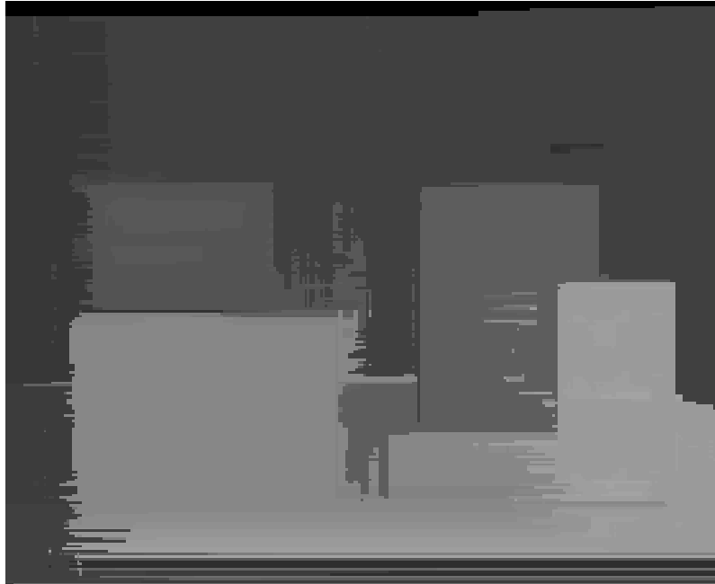
Abbildung 9.21: Mit dynamische Programmierung generierte Disparitätskarte. Die Helligkeit eines Bildpunktes repräsentiert den Abstand zum Weltpunkt. Je heller der Grauwert des Punktes im Bild, desto näher befindet sich der dazugehörige Punkt in Weltkoordinaten zur Referenzkamera.
