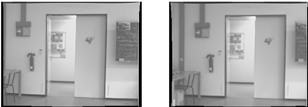
Abbildung 9.13: Stereobildpaar nach durchgeführter Entzerrung. Das Ergebnis der radialen Entzerrung ist gut erkennbar an langen Geraden in den Bildern (siehe Türrahmen und vergleiche mit dem Stereobildpaar aus Abbildung 9.12)
