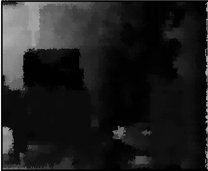
Abbildung 9.20: Mit Block-Matching generierte Disparitätskarte. Die Helligkeit der Bildpunkte gibt repräsentativ die Tiefe im Raum wieder. Je heller der Grauwert, desto näher befindet sich Weltpunkt zur Referenzkamera.
