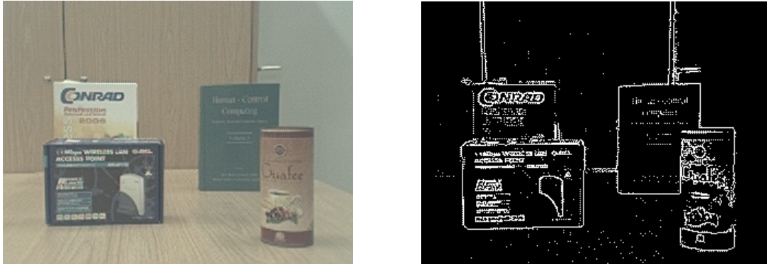
Abbildung 9.15: Originalbild (links) und Kantenbild (rechts). Das hier präsentierte Kantenbild einer Tischszene wurde durch Anwendung des Laplacian of Gaussian-Filters mit den Parameter \sigma = 0.7 und Fenstergröße 3 \times 3 generiert.
