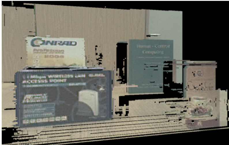
Abbildung 9.24: 3D-Rekonstruktion der mit dem Algorithmus von S. Birchfield und C. Thomasi generierte Disparitätskarte.
