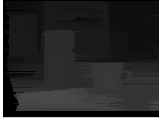
(b) Um ein kontinuierlicheres Disparitätsbild zu erhalten, wird die eigentliche Tiefenkarte mit einem Median der Größe 5 \times 5 Pixel geglättet.
