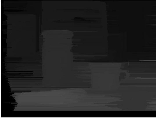
(a) Ergebnis des Birchfield-Algorithmus. Das Grauwertbild enthält deutlich fälschliche Ausfransungen der Objektkonturen.
