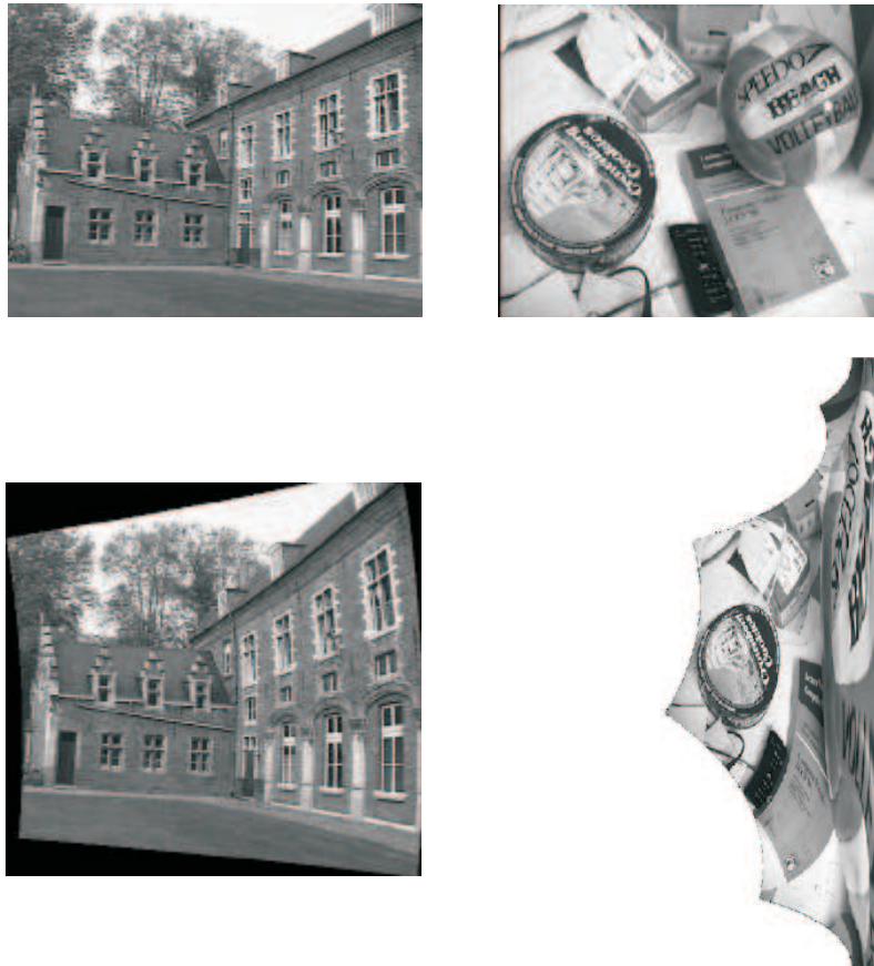
Abbildung 3.7: Beispiel für rektifizierte Bilder durch Umwandlung in Polarkoordinaten (jeweils nur für ein Bild des Stereobildpaares). In der Abbildung links oben liegt der Epipol rechter Hand des Bildes, in der Abbildung rechts oben mitten im Bild auf dem Volleyball (weißer Punkt). Quelle: [Pol00, Kapitel 7, S. 69].
