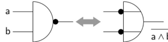
1. Ersetzen von *UND* durch *ODER* und umgekehrt  $\Rightarrow$  Austausch der Funktion
