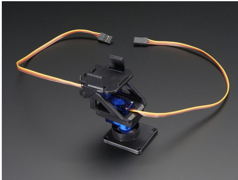
Abbildung 4: Mini Pan-Tilt Unit (PTU) basierend auf zwei Servo-Motoren.
