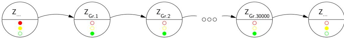
Dieser Ansatz hat jedoch mehrere Nachteile, weswegen man üblicherweise zwei (oder mehr) *gekoppelte Automaten* einsetzt: einen „Hauptautomaten“ der die Zustandsübergänge realisiert und einen Zähler (trivialer Automat), der für die Wartezeiten sorgt. Zählen Sie kurz auf (jeweils ein Satz zur Begründung), welche Nachteile dies sein könnten.
