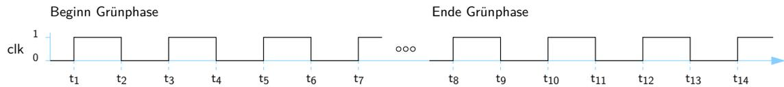
**Tip:** beim Taktschema gekoppelter Automaten ist entscheidend, wann die einzelnen Zustandsübergänge stattfinden. Durch die gegenseitigen Abhängigkeiten (Steuersignale und Zählerstände) kann es leicht vorkommen, dass man einen Takt „zu spät“ ist.
