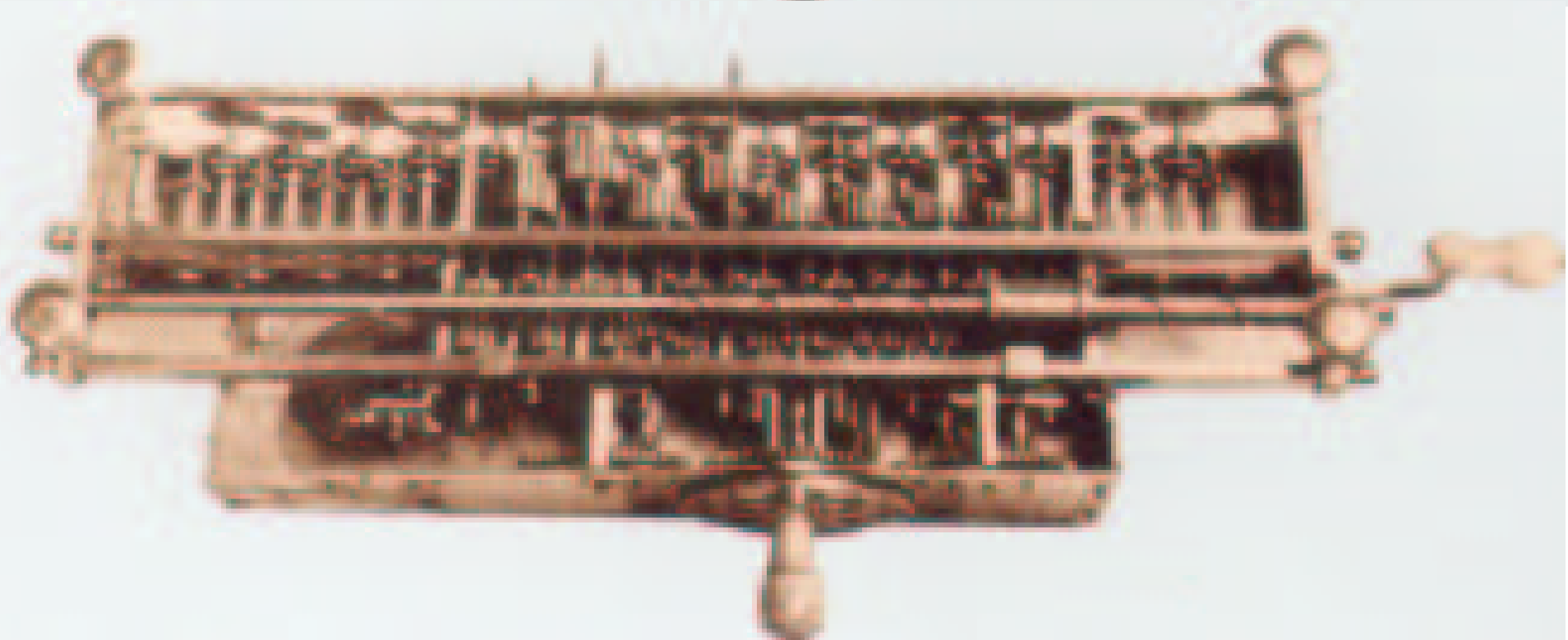
Rechenmaschine von Leibnitz mit Staffelwalze
