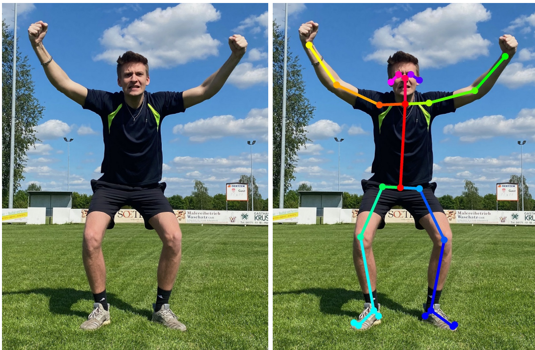
Abbildung 2.6: OpenPose: Input Bild und Output Bild mit body keypoints
