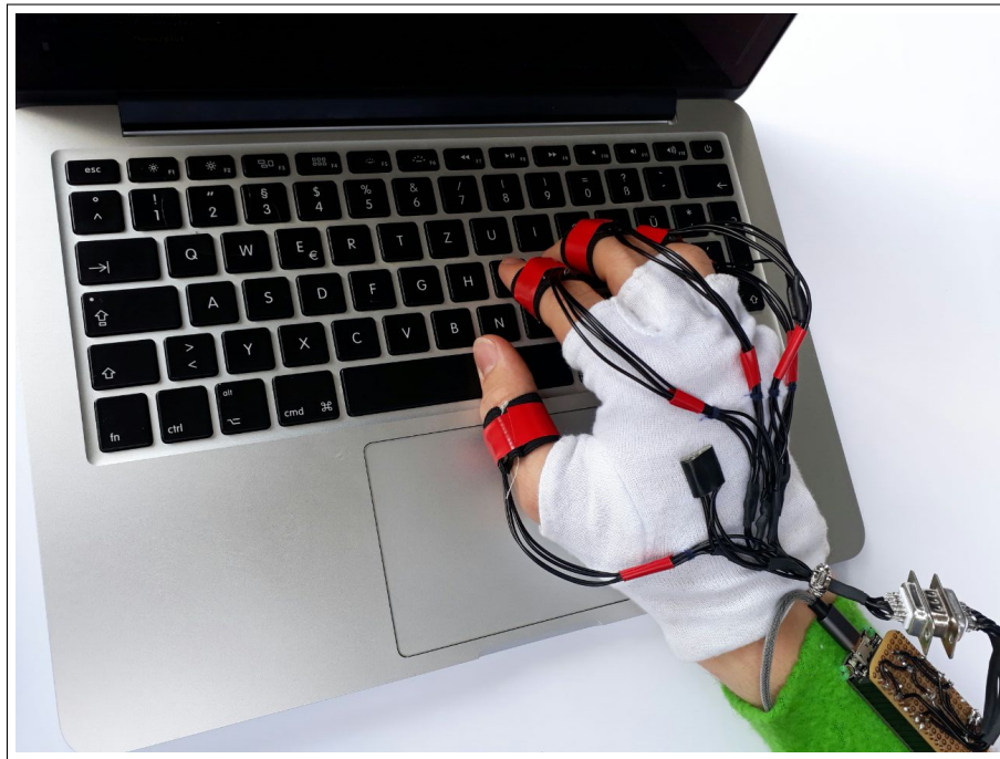
Abbildung 1: Der im Rahmen dieser Arbeit entwickelte Prototyp einer virtuellen Tastatur, hier gezeigt beim Aufzeichnen der Lerndaten. Am Handschuh sind die Sensoren (6 IMUs) sowie der Mikroprozessor befestigt. Auf den Mikroprozessor ist die Entwicklungsplatine aufgesteckt, welche Verkabelung der Sensoren ermöglicht.
