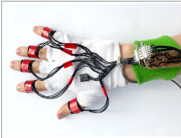
(a) Fertiggestellter Handschuh mit 6 IMUs auf den Fingern und dem Handrücken. Der Mikroprozessor wird durch eine Steckverbindung mit den IMUs verbunden.
