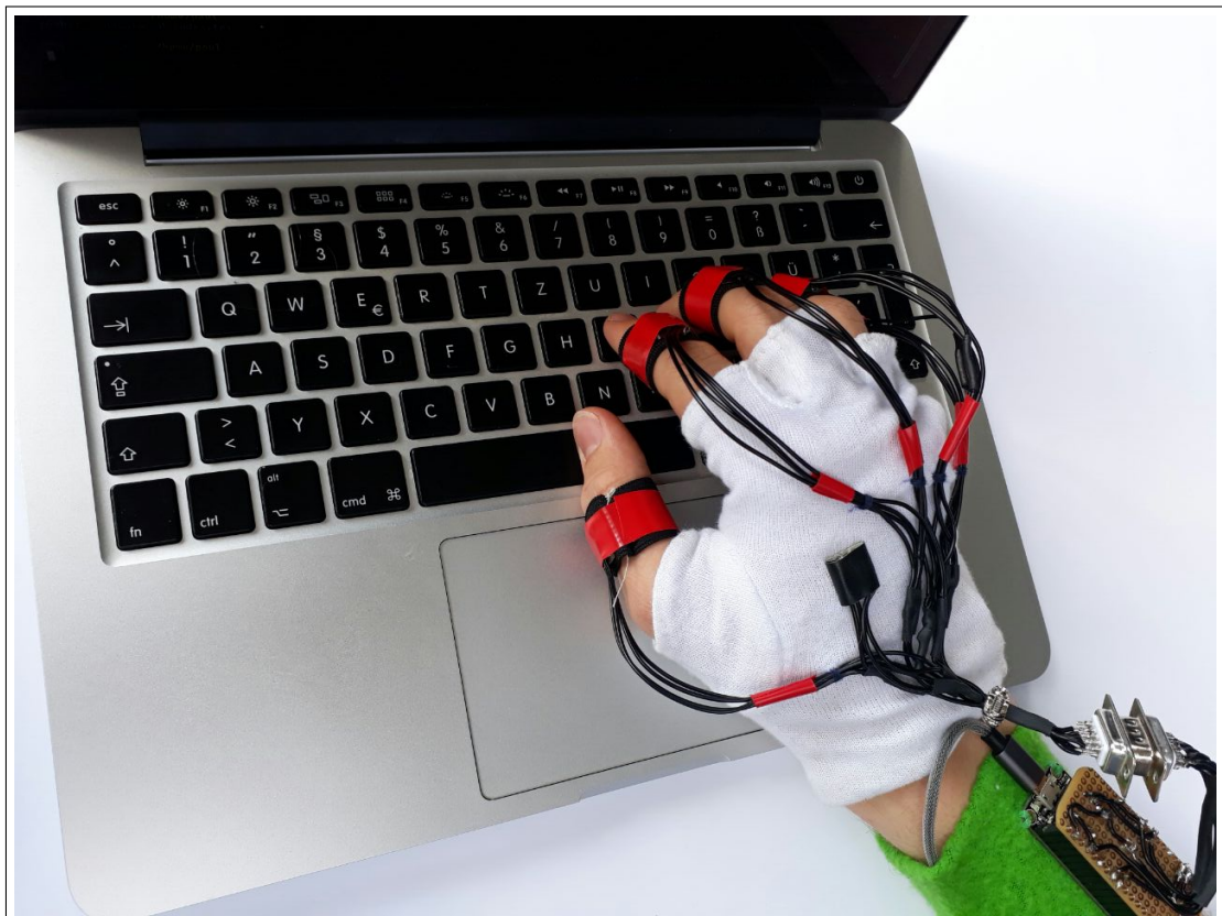
Abbildung 1: Der fertiggestellte Datenhandschuh während des Aufzeichnens der Lern- daten. Zu sehen sind die mit Gummiband befestigten Finger-IMUs, die Hand-IMU seitlich auf dem Handrücken sowie der Mikroprozessor mit Platine, welche auf einem Armband befestigt sind.
