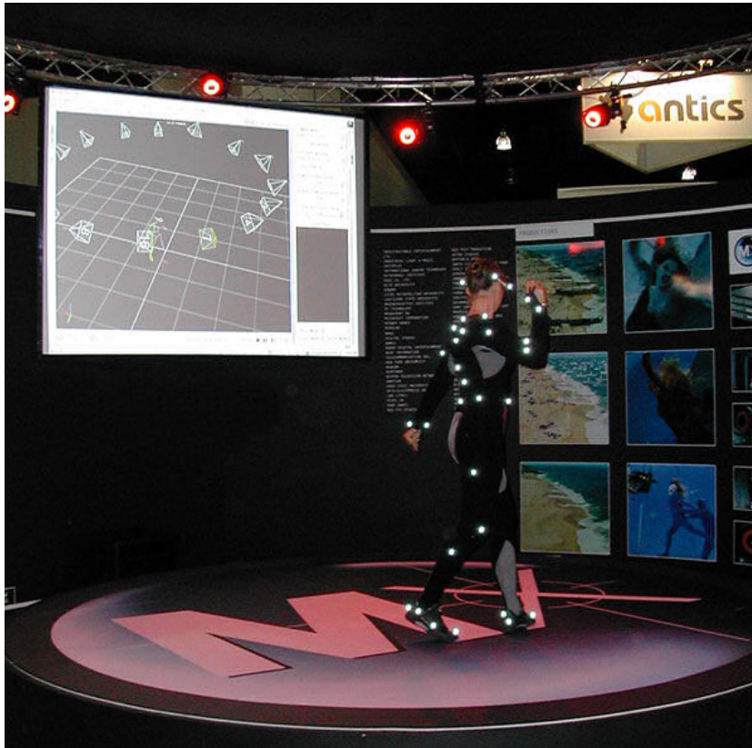
Abbildung 1: Passive Methode, die heutzutage kommerziell genutzt wird. Quelle: [Wik13d]
