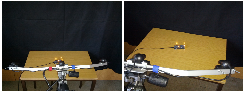
Abbildung 5: Versuchsaufbau mit drei Kameras und einem Arduino Due, mit vier LEDs als aktive Marker.
