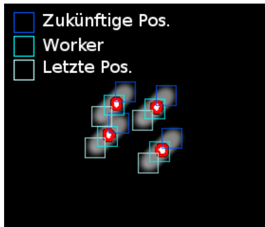
Abbildung 26: Ein Ausschnitt nach der Konturensuche mit optischen Hilfsmitteln zur Erklärung und skizzenhaften Darstellung. Innerhalb der weißen Striche befinden sich die LEDs. Die „Worker“ werden entsprechend ihrer aktuellen Position und der LED im weißen Feld gesetzt.
