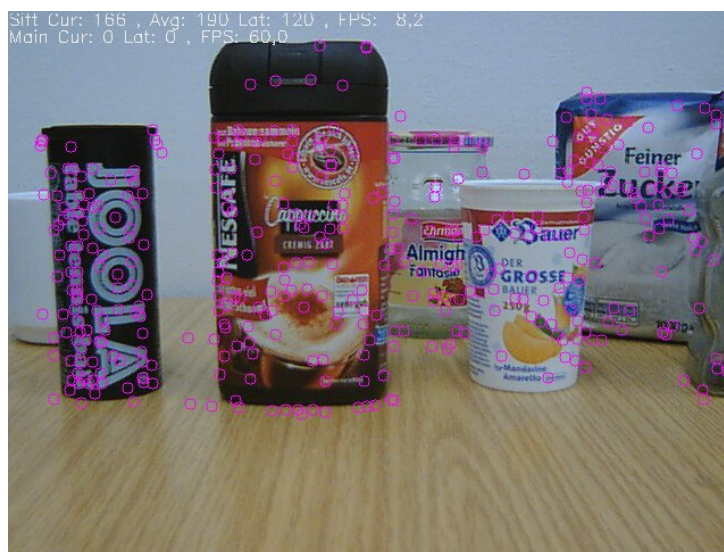
Abbildung 4.27.: Die Tischszene mit markierten SIFT-Merkmalen. Es ist zu erkennen, dass in dem oberen der vier horizontalen Abschnitte wenige, in dem unteren Abschnitt keine Merkmale gefunden werden. Es können mehrere Merkmale dicht nebeneinander liegen, so dass diese als ein Merkmal markiert werden. Daher sind weniger Merkmale erkennbar, als bei der Beschreibung zu Abbildung 4.26 angegeben.
