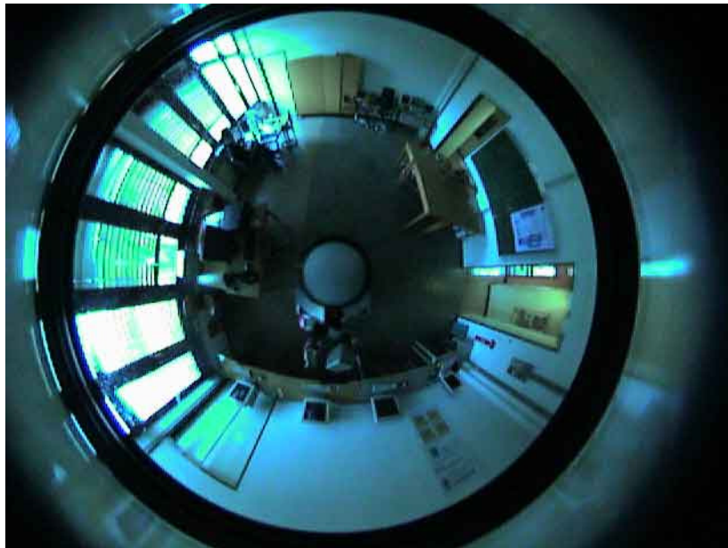
Abbildung 5: Darstellung der Umgebung durch ein Omnivisionssystem, damit werden 360° Bilder der Umgebung erstellt und können zu einem Panoramabild umgerechnet werden.
