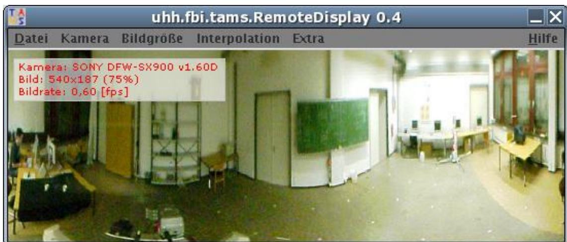
Abbildung 6: Ein umgerechnetes Panoramabild aus dem Omnivisionssystem des Roboters. Durch die visuelle 360° Panoramaaufnahme ist der Roboter, an der Uni Hamburg Fachbereich Informatik, in der Lage die gesamte Umgebung visuell zu erfassen.
