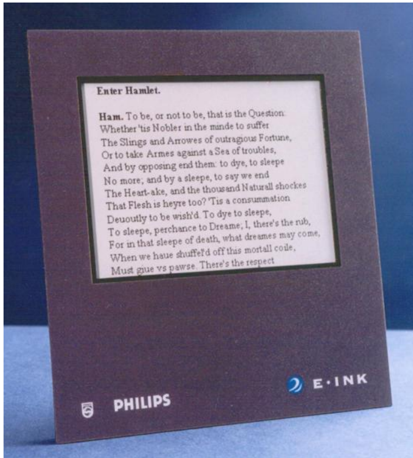
(Philips/eInk Prototyp, 80 dpi, Juni 2001)
