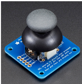
Abbildung 3: 2-Achsen Joystick basierend auf zwei Drehpotentiometern.
