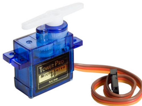
Abbildung 2: Micro-Servo mit einem Arbeitsbereich von 180 Grad.
