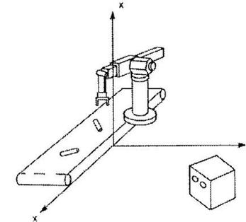
Zuerst wurden eine Reihenfolge von Positionen des Manipulator-Endeffektors ( $p_n$ ) spezifiziert.
